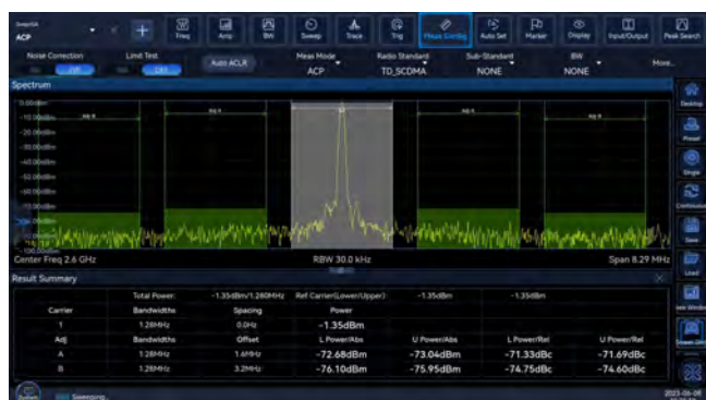
Измерение мощности соседнего канала
